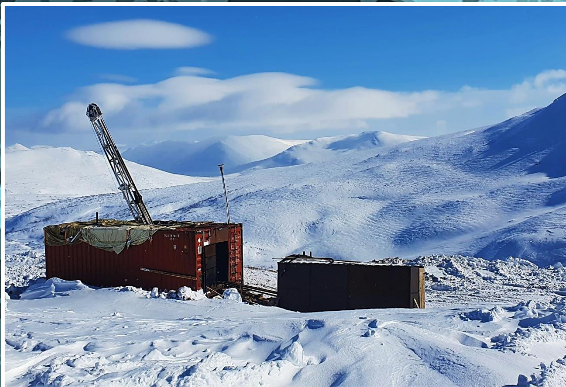
Буровая установка RS-90 на площадке скважины V2301 на рудной зоне № 2. Ветроваямское рудопроявление золота. Участок «Чеинг». 2023 г.
